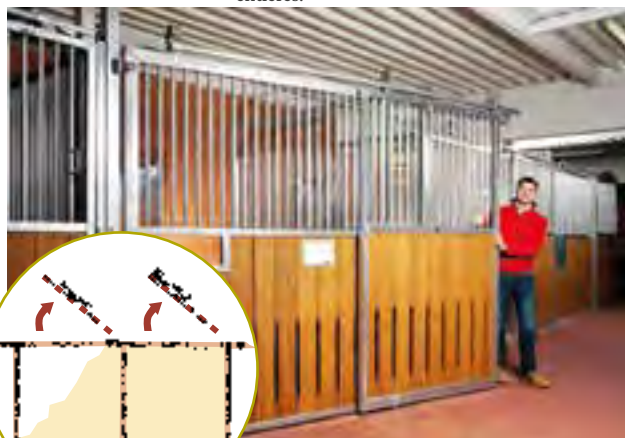
4 S'il est prévu d'enlever le fumier de boxes individuels avec un tracteur articulé, la paroi façade pivotante est une solution idéale.
