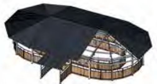
Ovale Führanlage mit Komplettdach
